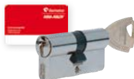
Barillet V5 Néo avec fonction clé de secours permettant l'ouverture même si la clé est restée à l'intérieur, barillet fourni avec carte de propriété – 4 clés.
