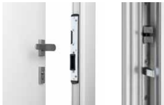
Serrure à goudjons 6 points (2 goudjons, 3 pènes 1/2 tour et 1 pêne dormant - conforme classe sécurité RC2)
